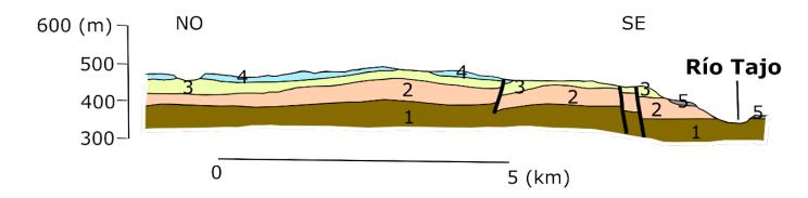
**2.** En el corte geológico orientado NO-SE se presentan una serie de litologías compuestas por: (1): Yesos, (2): Brechas calcáreas, (3): Conglomerados y areniscas, (4): Calizas tobaceas, (5): Gravas poligénicas, arenas, limos, arcillas (terrazas).
