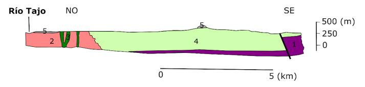
**1.** En el corte geológico orientado NO-SE se presentan una serie de litologías compuestas por: (1): Granitoides y migmatitas, (2): Granitos y/o monzogranitos, (3): Dique de cuarzo, (4): Pizarras, (5): Gravas poligénicas, arenas, limos, arcillas (terrazas). La edad de los materiales es acorde la numeración, de lo más antiguo (1) hacia lo más reciente (5).
