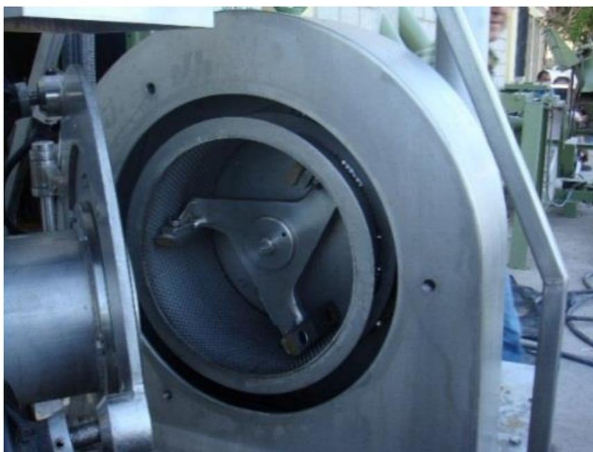
*Aspecto externo (arriba) e interno (abajo) de un molino de martillos*
