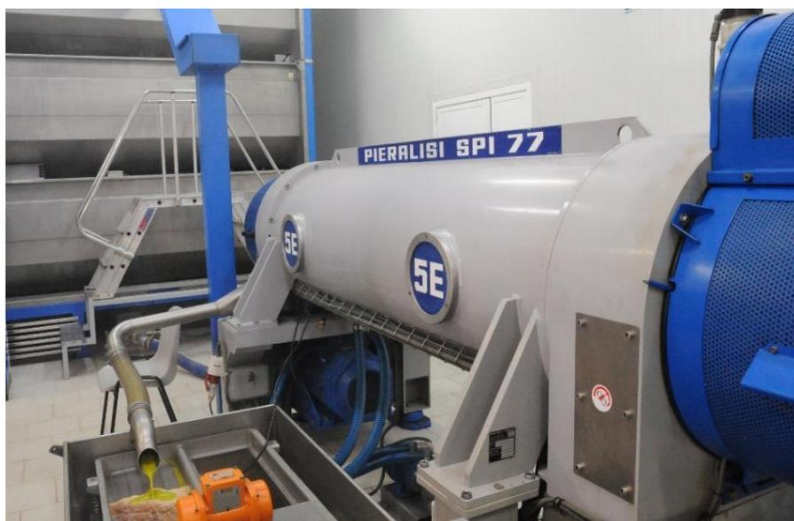
*Centrífuga horizontal (decánter) de dos fases o salidas*
