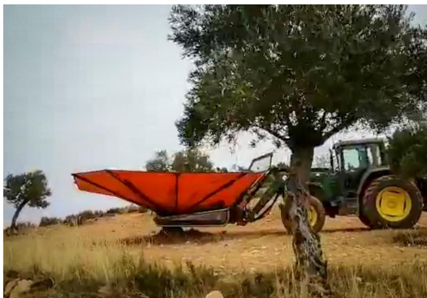
*Recolección mecanizada de la aceituna mediante vibrador multidireccional portante (arriba) y vibrador con paraguas (abajo)*
