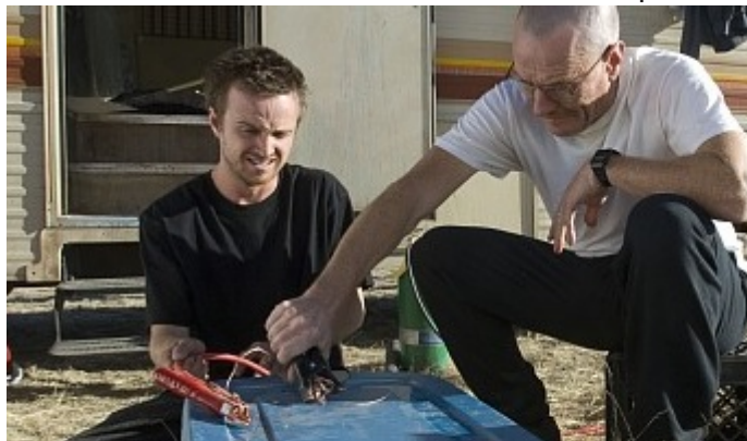
Conectando las baterías en serie a la caravana
