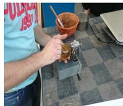
Por otro lados la caracterización de la cascara de almendra se realizan ensayos de laboratorio basados en la caracterización de áridos. Los datos mas significativos son los obtenidos en la absorción de agua, dado que se utilizara la cascara saturada para que no absorba el agua de amasado, así como su baja densidad.
