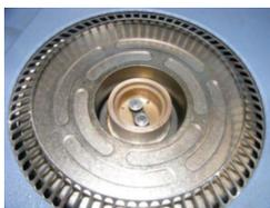
La calorimetría diferencial de barrido o DSC es una técnica termoanalítica que consiste en someter una muestra del material a estudiar y una cápsula de referencia a un incremento de temperatura lineal en función del tiempo. La referencia contará con una capacidad calorífica definida en el intervalo de temperatura en el que se realiza el barrido, por lo que la diferencia entre el calor de la muestra y la referencia permitirá evaluar el comportamiento del material.
