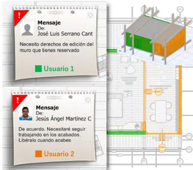
Todo ello, complementado por la mensajería integrada en ArchiCAD, que fluidifica y automatiza la comunicación entre agentes. Las superposiciones entre modelos IFC se identifican con Tekla BIMsight (comprobador de la calidad de modelos y su interrelación en entornos de colaboración externa), donde se pueden añadir comentarios a través del Formato de Colaboración BIM (BCF), facilitando la coordinación y corrección de diseños, paralela a la realizada desde ArchiCAD de forma interna.
