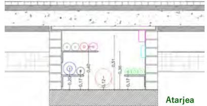
En la zona común se proyecta la construcción de una atarjea para el transcurso de las instalaciones, con el fin de que todas las tuberías y canales sigan un recorrido uniforme, se eviten cruces entre ellos y cumplan la normativa, y así agruparlas para futuras inspecciones, ampliaciones o renovación.
