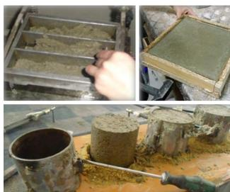
Se fabrican 151 probetas para la campaña de ensayos, de las cuales, 105 son prismáticas de 40 × 40 × 160 mm, otras 42 probetas cilíndricas utilizadas para el ensayo de acústica, que se dividen en 21 de 100 mm de diámetro y las otras 21 de 2,9 mm; y por último, las 4 restantes son utilizadas para el ensayo térmico. Para llegar a este cómputo de probetas han sido necesarias 63 amasadas, excluyendo las necesarias para determinar la cantidad de agua necesaria en la dosificación.
